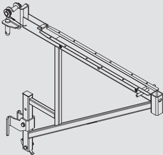
La console de travail MXK se fixe sur les contreventements du coffrage cadre ; celle-ci sert de support pour les platelages MXK. Une autre solution consiste à clouer des madriers bois par en-haut ou à les visser par en-bas.
