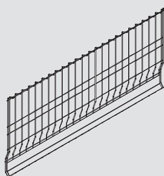
La grille de protection latérale monobloc PMB sécurise la plate-forme de travail parallèlement au coffrage et se monte rapidement. Les longueurs disponibles sont adaptées aux platelages MXK. Une autre solution consiste à utiliser la grille de protection latérale PMB avec des éléments standards PROKIT pour la sécurisation de rives de dalle libres.
