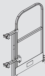
Le portillon d'about MXK avec plinthe intégrée sécurise le bord ouvert de la plate-forme de travail perpendiculairement au coffrage cadre. Celui-ci peut pivoter de 90° dans les deux sens, ce qui permet l'accès à la plate-forme de travail suivante.
