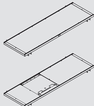
Le platelage MXK est, grâce à des longueurs de 240 cm, 120 cm et 90 cm, adapté aux coffrages cadre MAXIMO et TRIO. La surface de travail est livrable avec un panneau bois enduit de haute qualité. Sont également disponibles des platelages en acier, sur lesquels ne peuvent s'accumuler qu'une quantité minimale d'eau, de neige et/ou de glace. Les platelages de 240 cm de long sont également disponibles avec trappe d'accès.
