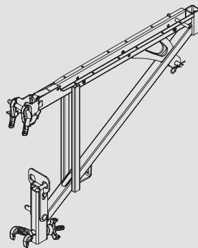
La console MXK-RS offre en outre la possibilité de raccorder directement un étai de réglage à la console. En présence d'éléments superposés, on est ainsi assuré que les étais de réglage n'entravent pas la zone de travail sur la plate-forme.
