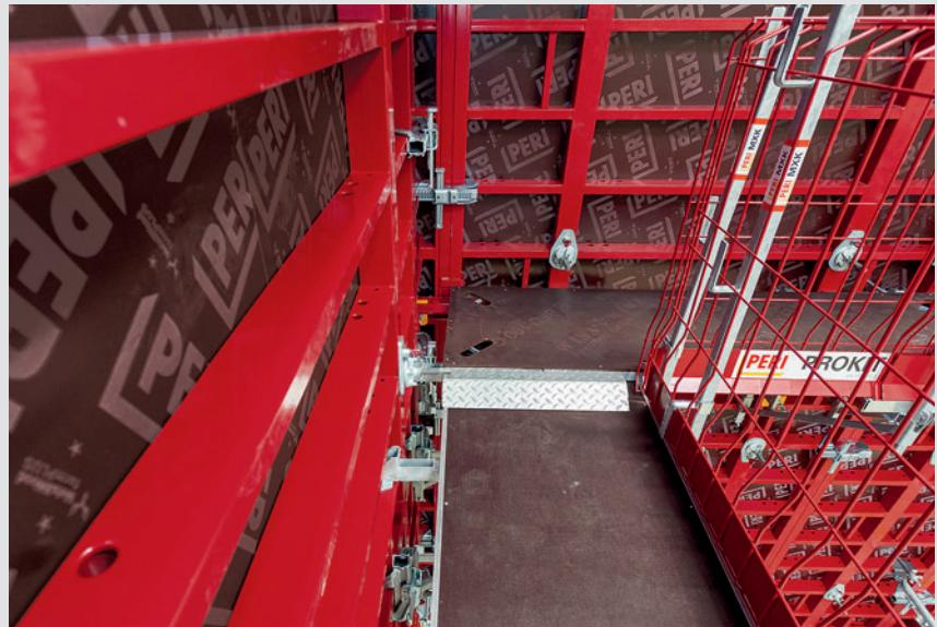
Le platelage d'angle extérieur MXK se monte sur les consoles de travail MXK. Le montage est effectué sur l'élément couché.
