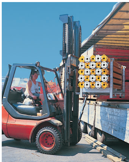
Les palettes à montants PERI sont adaptées aux cotes de chargement des camions.
